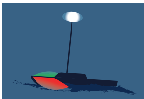
Laeval pikkusega vähem kui 12 m võib ringtuli olla ahtri- ja topitule asemel
